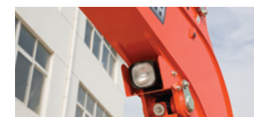
工作灯位于动臂正下方，夜间作业轻松无盲点
